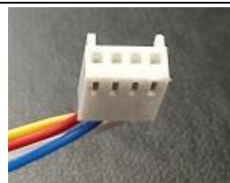
Fan Connector A - 10V, B - 0V, C - PWM & D - Tacho
